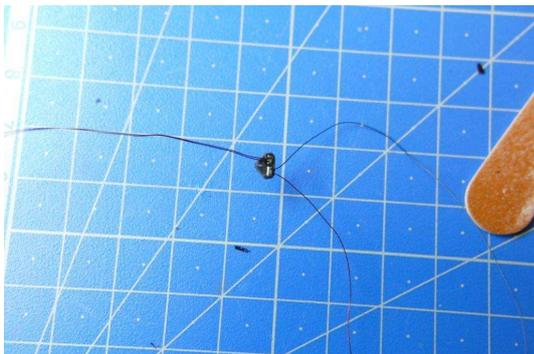
Wenn der LED-Halter, wie auf dem Bild gezeigt, auf der Vorderseite liegt (kleines Loch links), muss die grüne LED unten und die rote LED oben verklebt werden.
